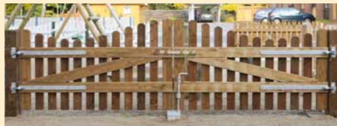
Lichter Pfostenabstand = Torbreite + 4 cm
